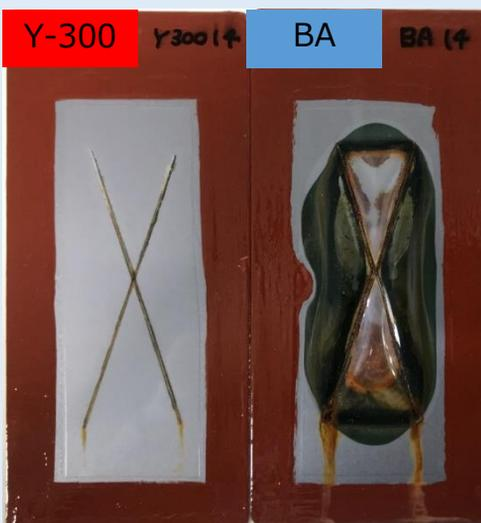
※ 试验条件：盐水浓度5%、盐水蒸汽饱和温度47℃、试验箱温度35℃
